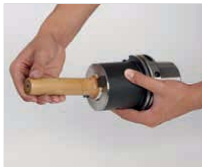
3. Čištění vnitřního kuželu a čelního nástavce
