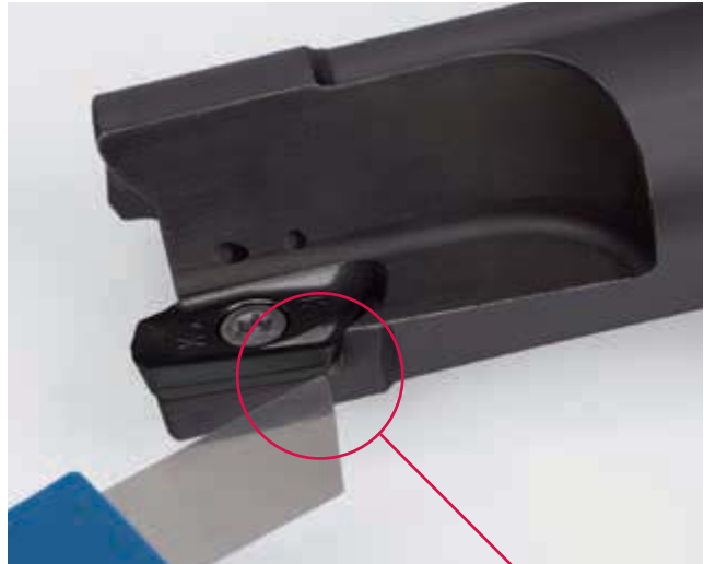
Kontrola pomocí fólie 0,01 mm
