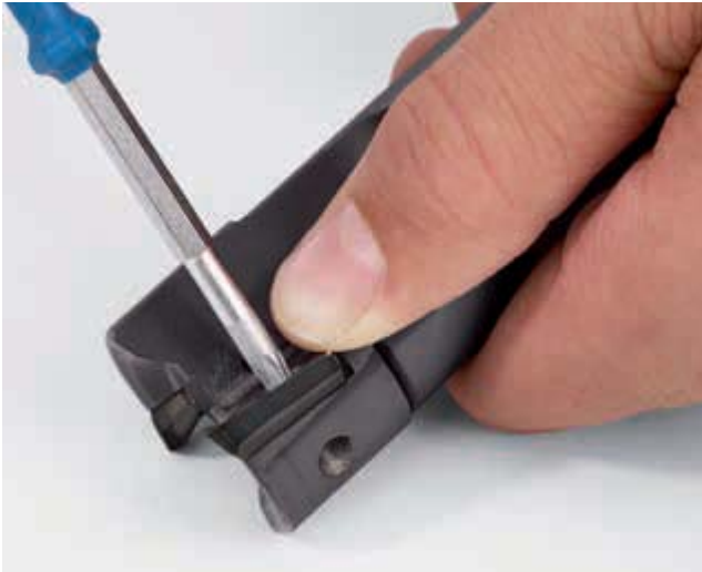
Přítlačení zadní části vyměnitelné břitové destičky při utahování
